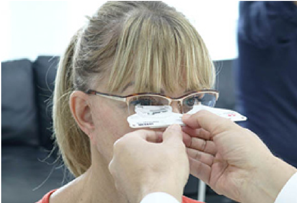
Die Krümmung der Linse wird gemessen
